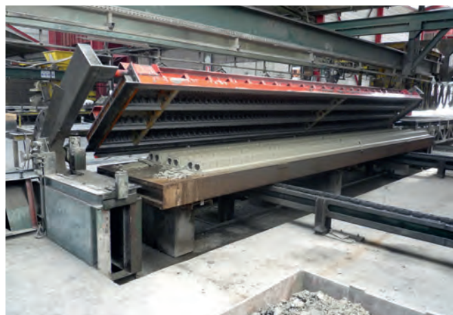
Карусельная установка для ненапрягаемых пустотных плит
