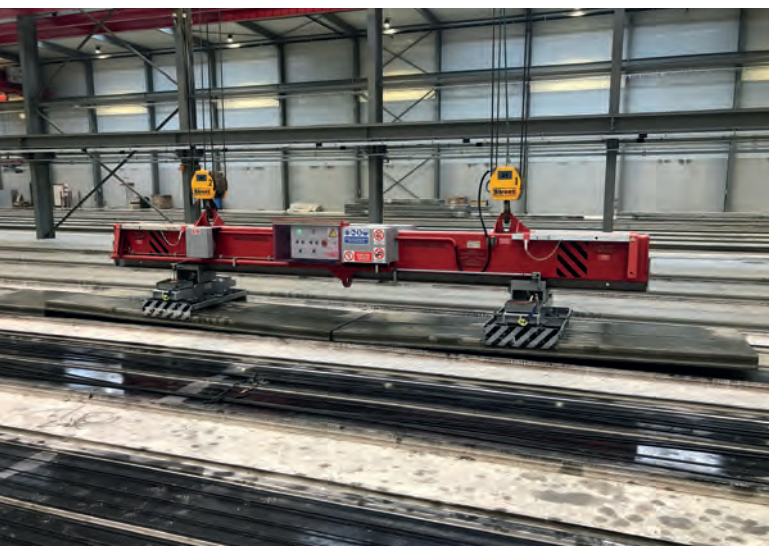
Подъем пустотных плит перекрытия с помощью телескопической подъемной балки и мостового крана
