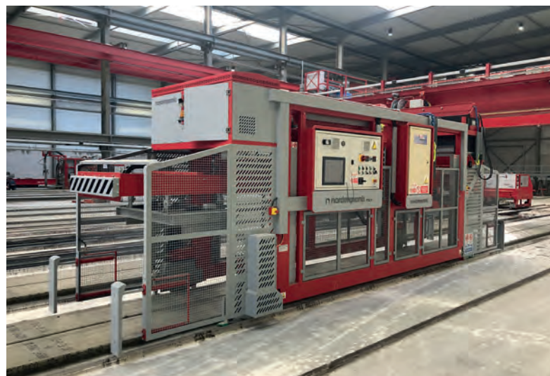
Подъем пустотных плит с помощью новой подъемной машины, разработанной Nordimpianti
